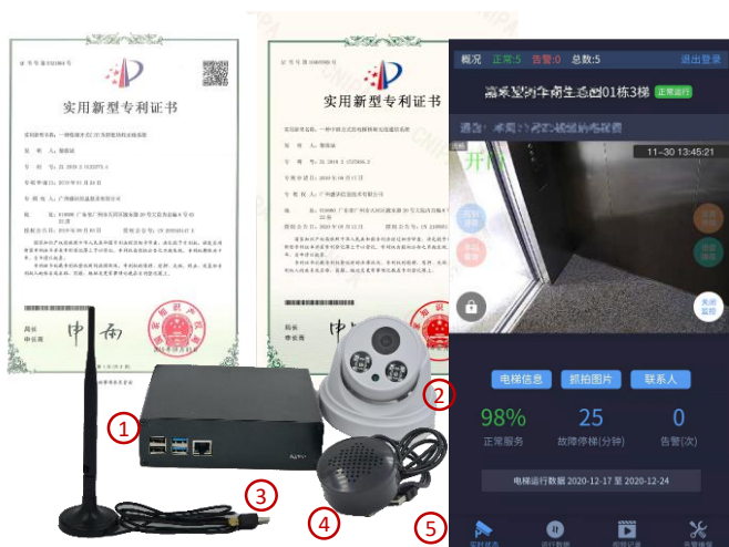
电梯运行数据收集硬件：#1 含运动传感器和视频处理能力的监测主机； #2 高清摄像头；#3 有源喇叭；#4 高功率无线天线；#5 移动用户界面
